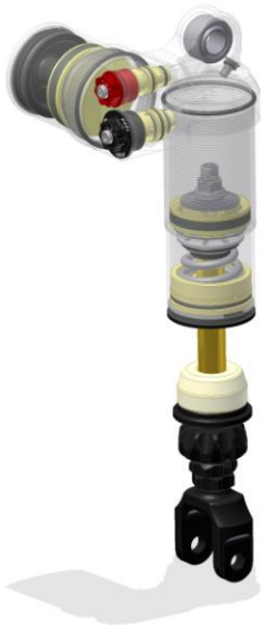
Vista transparente de un amortiguador moderno de una motocicleta deportiva.
